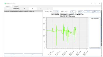
SWDCC是一款无线数据回收和实时显示软件平台(Windows系统运行)。在网络通讯正常的情况下，用户通过软件配置接口与网关或无线通讯模块连接，即可实现数据的实时回传或历史数据下载。
