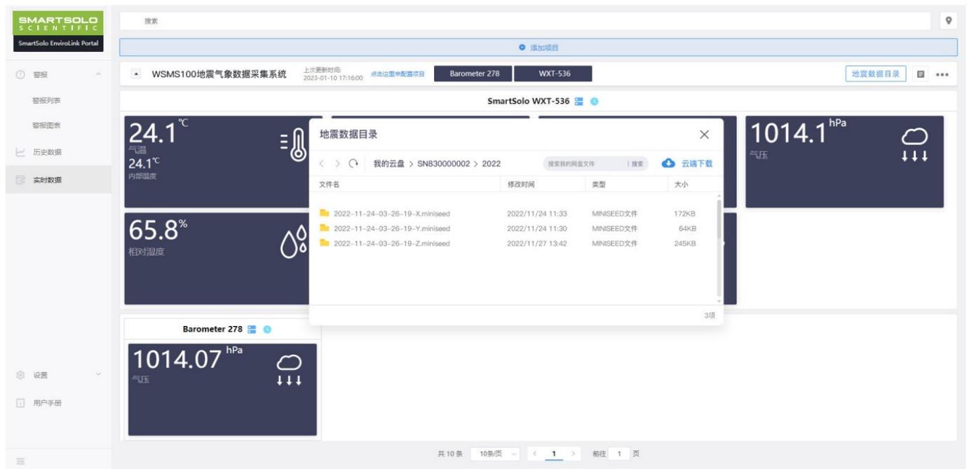
在网络通讯正常的情况下，用户可通过SmartSolo EnviroLink Portal选择目前采集系统的网关和节点式数据记录仪，并设置采样频率。配置完成后，相关的测量数据返回到云服务器或并存储到指定云盘，再通过EnviroLink界面显示实时数据或查看数据状态。
