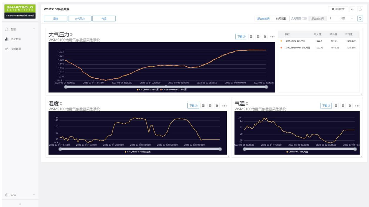
在网络通讯正常的情况下，用户可通过SmartSolo EnviroLink Portal云平台选择目前采集系统的网关和节点式数据记录仪，并设置采样频率。配置完成后，云平台【实时数据】界面会显示物理量实时数据、采集时间以及设备运行状态。
